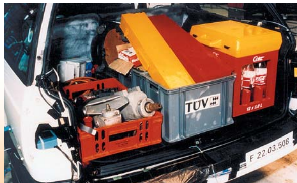
Ungesicherte Ladung im Handwerker-Kombi , Gesamtgewicht 100 kg. Bei dem Crashtest wird das Fahrzeug frontal mit einer Geschwindigkeit von 48,7 km/h an die Wand prallen.
