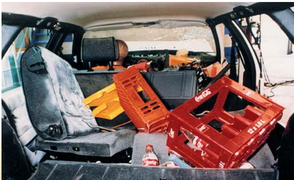
Der Dummy wird von hinten durch die schweren, fliegenden Teile am Kopf getroffen. Die Rückenlehne des Beifahrersitzes wird vollständig nach vorne weggedrückt.
