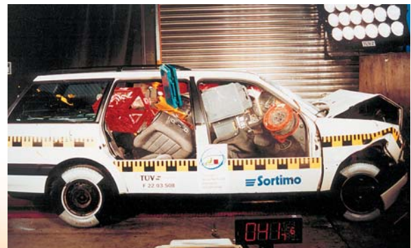
Das gesamte Crashgewicht beträgt 1330 kg. Die 100 kg Ladung haben bereits nach 485 Millisekunden den vorderen Teil des Fahrzeuges und die Windschutzscheibe erreicht.
