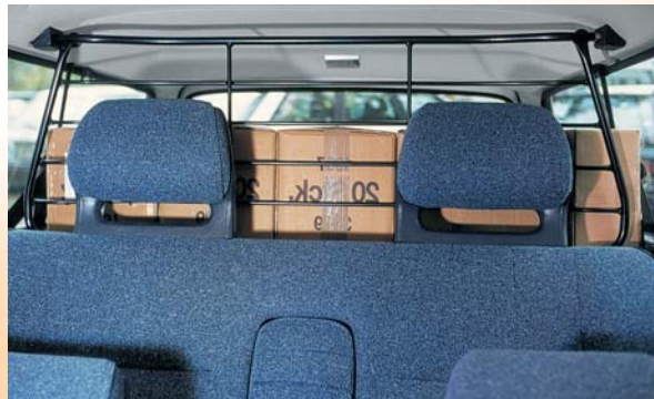
Damit die Ladung im Pkw-Kombi beim starken Bremsen nicht nach vorne geschleudert wird, sollte man den Lade- und Sitzraum zum Beispiel durch stabile Schutzgitter voneinander trennen.
